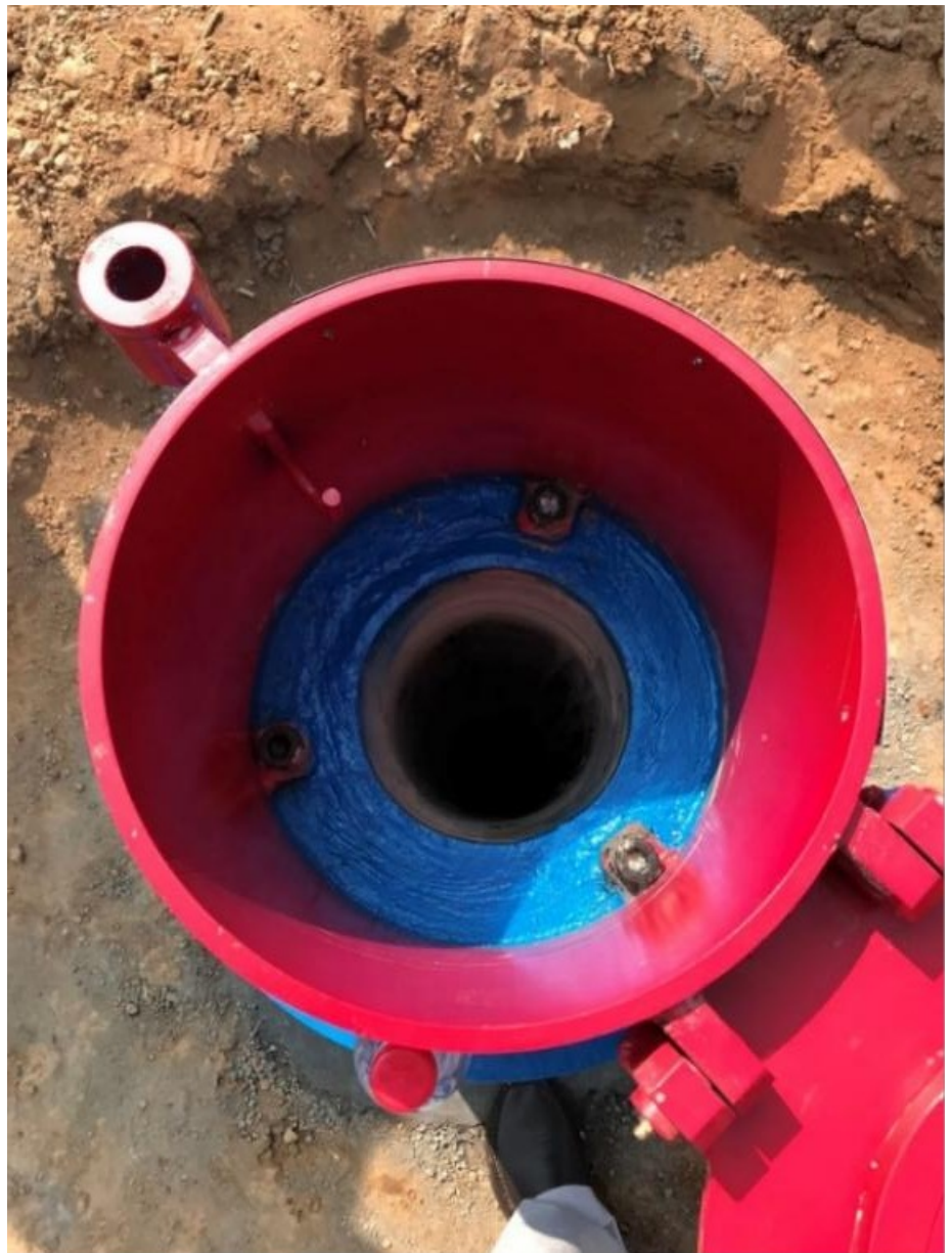
图1 孔口保护装置示意图
